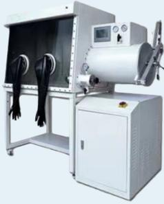
真空手套箱用于成品粉末的包装处理。箱体采用304不锈钢材质，内有进口除氧、吸水材料，手套箱内水、氧成分可长期持续保持气体纯度在1ppm以下，保证粉末包装环节的环境氛围。首次使用箱体前要把箱体内的空气置换为惰性气体，通过过渡舱进行物料填充。设备的系统净化可以选择自动模式或手动模式，自动模式下系统将自动的保持箱体内设定好的气氛条件。设备还带有在线工况检测、数据记录、控制器贮备、多级安全保护报警等功能。
