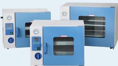
粉末在后处理过程和长期储存过程中受外部环境影响，湿度会增加，影响成粉的流动性，真空干燥箱用于粉末的干燥处理。真空干燥箱采用立式结构，304不锈钢材质。长方体工作室，使有效容积达到最大；微电脑温度控制器，控温精确可靠；钢化、防弹双层玻璃门观察工作室内部物体，一目了然，能够向内部充入惰性气体；箱门闭合松紧可调节，整体成型的合成硅密封圈，确保箱内保持高真空度；储存、加热、试验和干燥可在没有氧气或者充满惰性气体环境里进行，不会导致粉末氧化。
