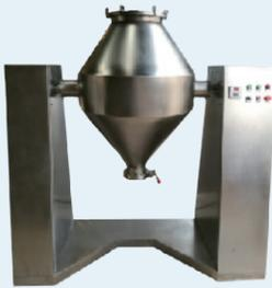
混料机主要用于不同粉罐内的出炉粉末或不同批次粉末的合批处理，适合两种或两种以上物料比重悬殊较大的混合。利用重力混合，物料在料桶内不断聚中，不断分散，混合时间一般为30分钟，混合均匀度达99%以上。混合筒内外壁经精密抛光处理，表面光滑、平整、无死角、易清洗，加有惰性气体置换口。
