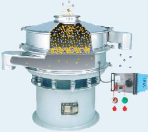
惰性气体保护超声波筛分机用于粉末的粗筛分处理。在三次元振动筛分过滤器（旋振筛）的基础上增加了惰性气体保护功能和直接作用于筛网的超声波发生器。通过将超声波换能器固定到不锈钢架上，与筛网紧密接触，使换能器的超声波频率通过变换板传到整个筛网上。超微细粉体接受巨大的超声加速度，从而抑制粘附、摩擦、平降、楔入等堵网因素，提高筛分效率和清网效率。
