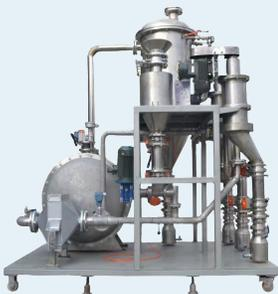
惰性气体保护气流分级设备采用全封闭负压循环运行，用于粉末的精细筛分处理，工作介质为氮气或氩气，主体采用304不锈钢材质，采用PLC编程控制，尽量减少人为操作和控制因素，控制柜位于设备旁，或放于远处单独的控制房，完全做到无人操作。
